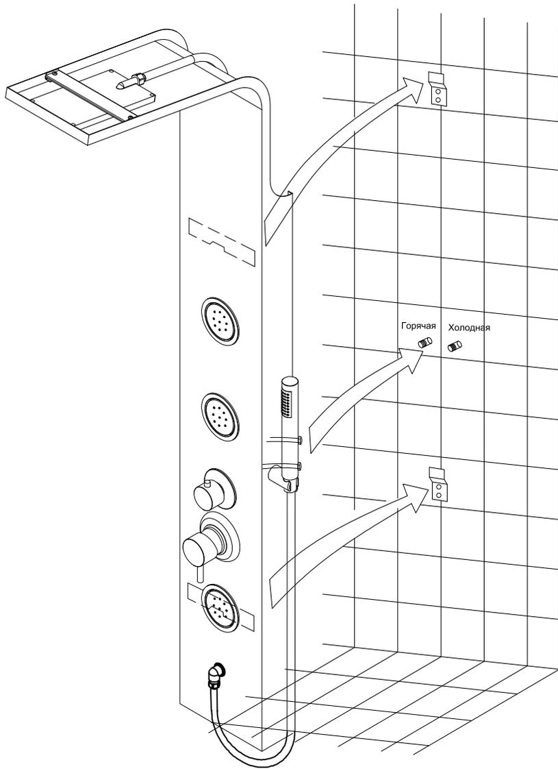
7. Подключите впускные шланги с соответствующими шлангами подачи воды. Красный для горячей и синий для холодной воды.
