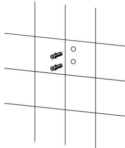
4. Затяните винты в стене для крепления настенного кронштейна.
